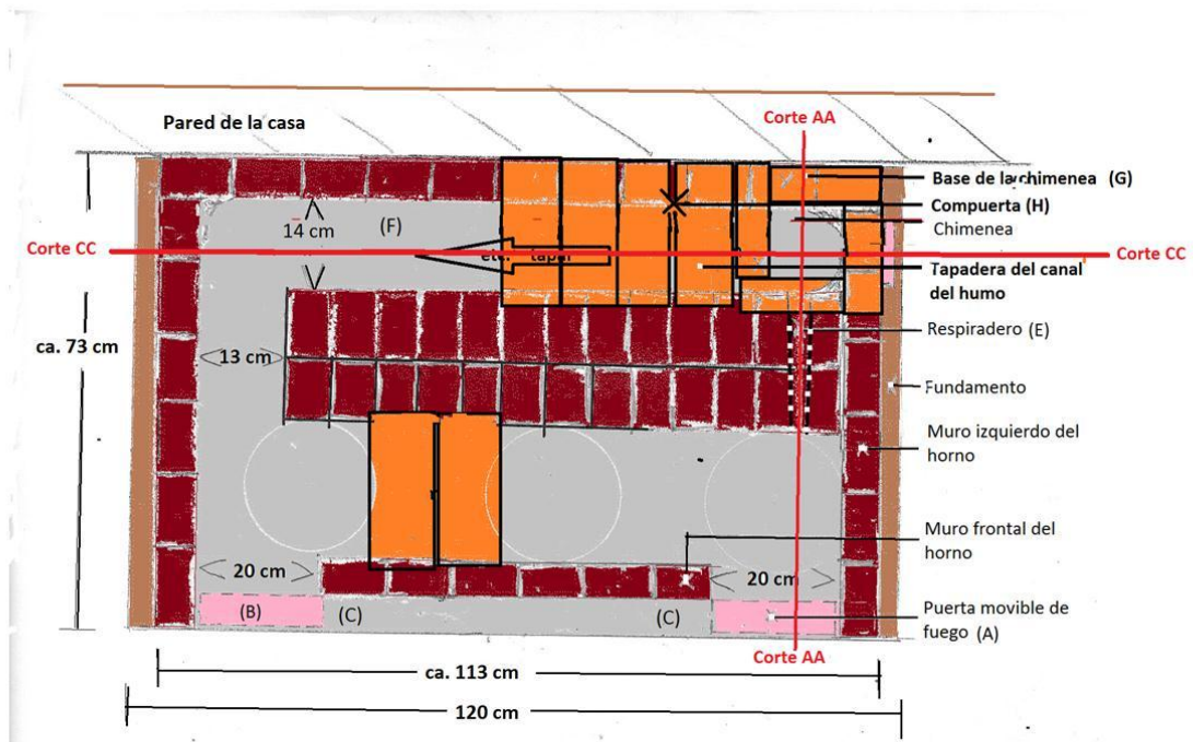
Fig. 109 : Tapadera del fogón Mod.1 Vista superior
